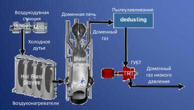
✓ выработка 28 МВт электроэнергии за счёт утилизации энергии давления доменного газа, без использования топлива.
