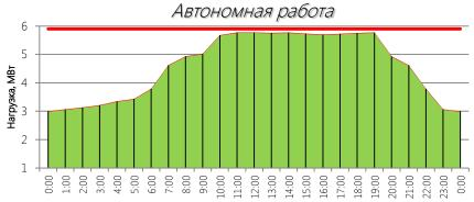
При автономной работе генерации выработкой оборудования обеспечивается вся потребность объекта. Ограничение загрузки оборудования исключительно технологическое (паспортное).
