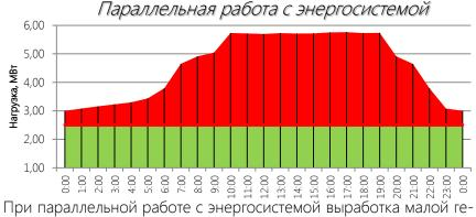
При параллельной работе с энергосистемой выработка малой генерации поддерживается на едином уровне, не превышающем минимальной часовой нагрузки.
